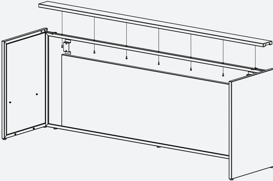
**7.2** Ensamble la placa de cubierta con 2 piezas m6x16, tanto en el lado izquierdo como en el derecho.
