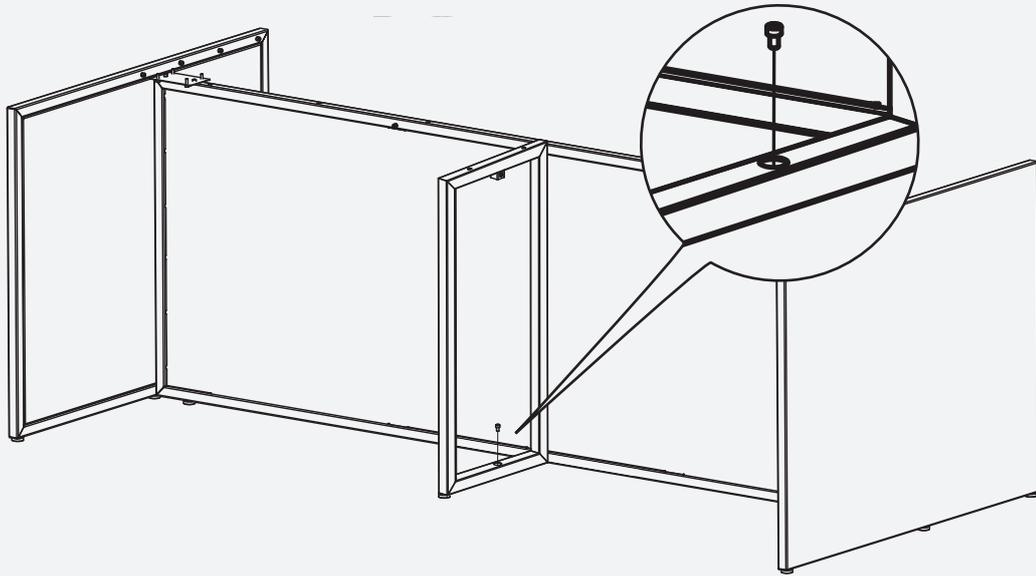
**7.6** Para ensamblar el panel superior, vea el paso 8. Monte el soporte del panel con 2 piezas M6x16, contra el panel superior.
