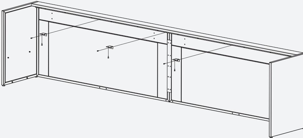
**7.4** Paso 7.4-7.7 solo para **Kitchen Island 7 y 8 con barra**. Montar soporte inferior para soporte de barra 2 piezas M6x16.
