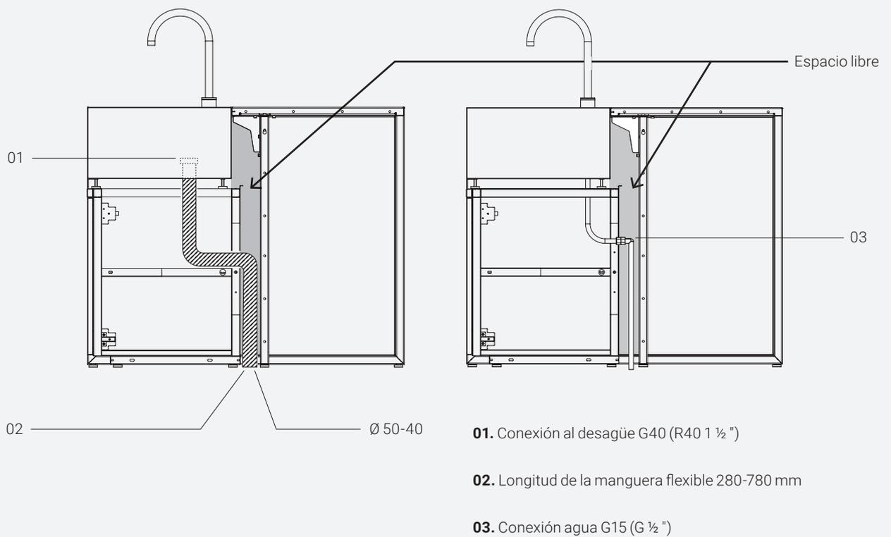
Desagüe / tubería de agua:
