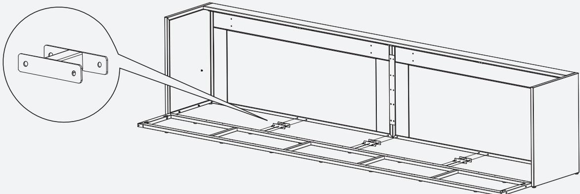
15. Ensamble el marco de la base con 4 piezas M6x16. No apriete completamente para permitir el ajuste.
