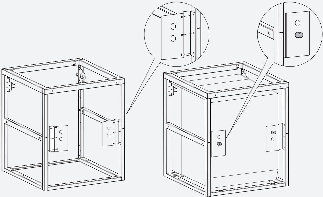
Posibilidad de cambiar la posición de las bisagras y mecanismo de cierre a izquierda / derecha.
