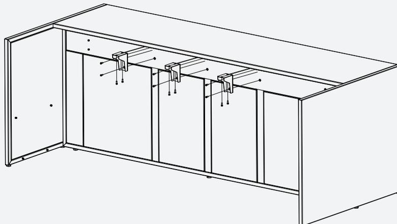
12. Ensamble 4 cubiertas para panel superior, barra y lado de la cocina, con 8 piezas M6x16.
