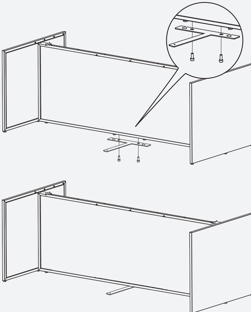
**7.5** Montar el soporte del panel con 1 pieza M6x16.
