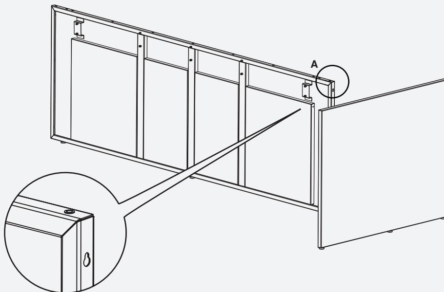
5. Monte los 5 tornillos restantes con 5 piezas M6x16. No apriete completamente para permitir el ajuste.
