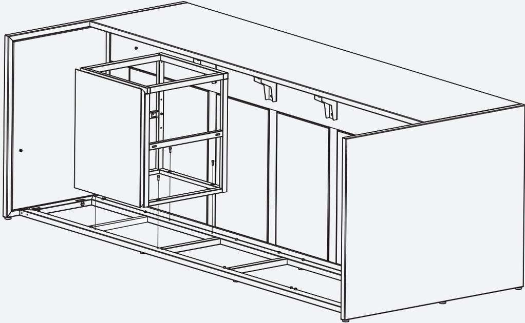
**17.** Ensamble los gabinetes en el lado izquierdo y derecho en el panel lateral con 2 piezas M6x16.
