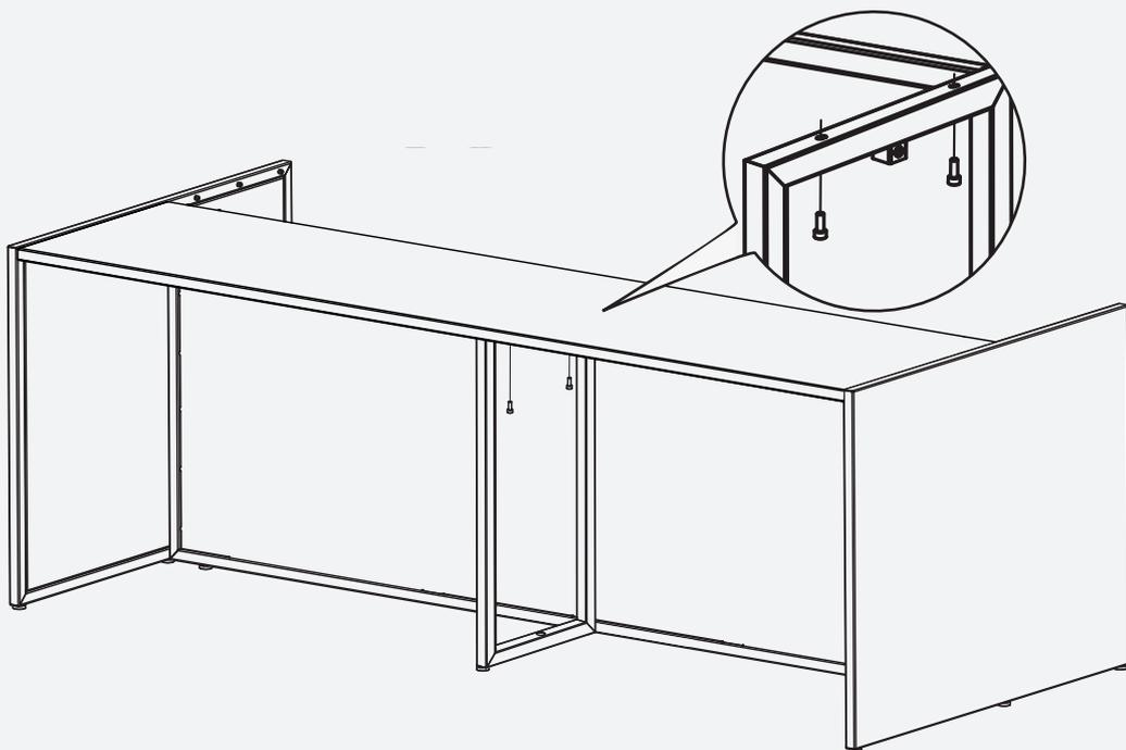
**7.7** Monte la cubierta en el lado izquierdo y derecho del soporte del panel con 2 tornillos. (premontado en el soporte del panel)
