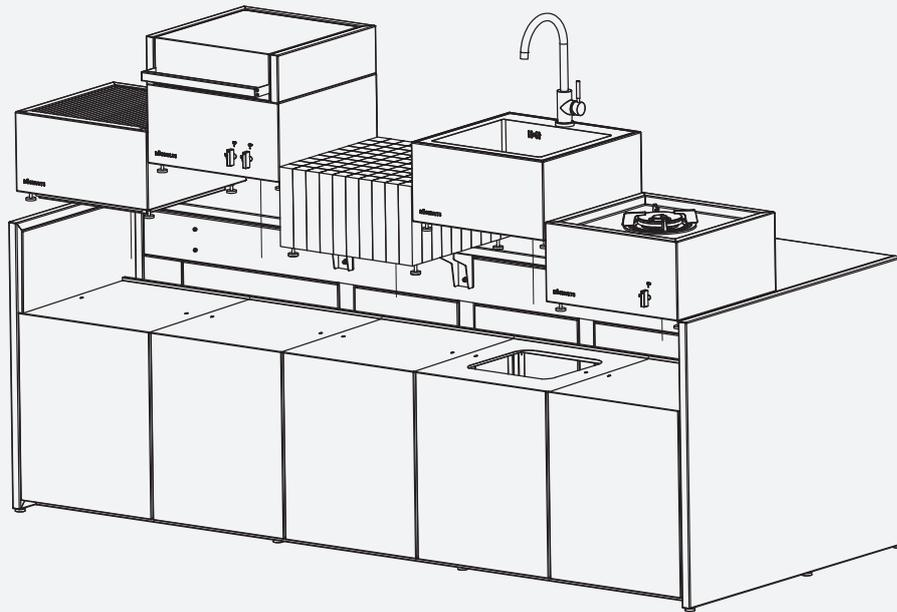
24. Si es necesario, ajuste los pies del módulo para alinearlos con el panel superior y otros módulos, y apriete las tuercas de seguridad.
