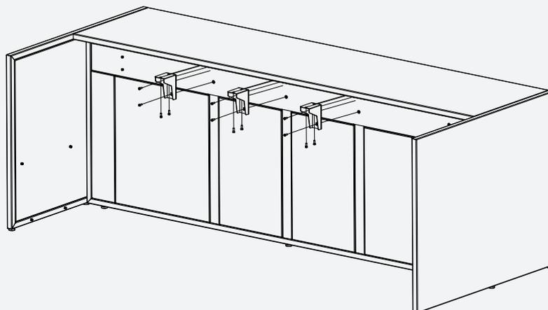
12. Montieren Sie 4 Schrauben. Abdeckungen für Oberplatte, Bar- und Küchenseite, mit 8 Stk. M6x16.
