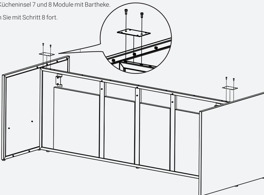
**7.1** Ohne Bar. Montieren Sie die obere Platte mit 7 Stück M6x16.
