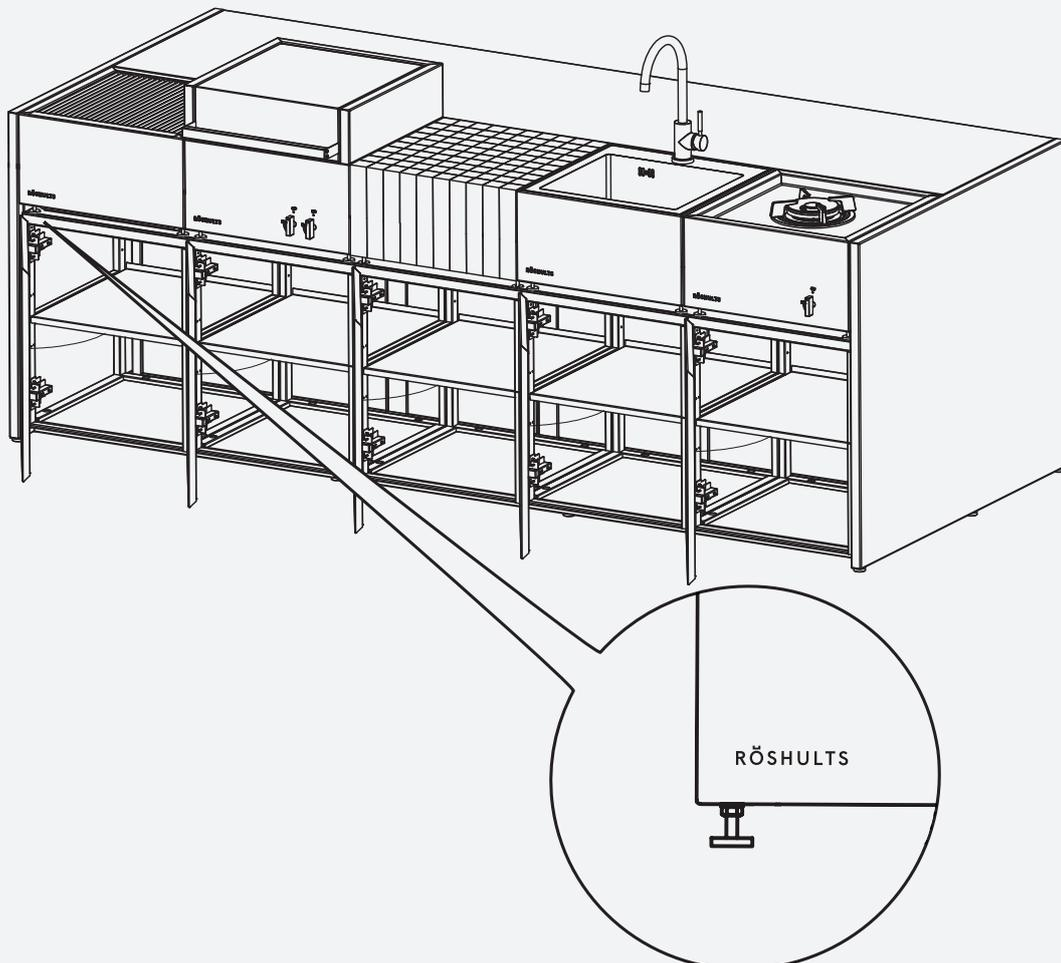
25. ⚠ **Achtung!** Sichern Sie jedes Modul mit 2 Schrauben zur Befestigung der Module an der obersten Ablage des Schrankes.
