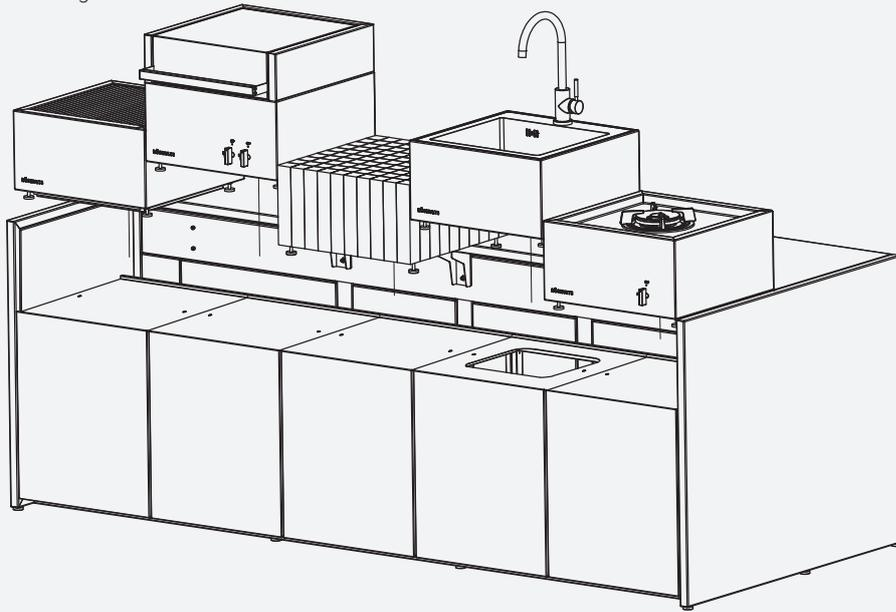
24. Stellen Sie bei Bedarf die Modulfüße so ein, dass sie mit der oberen Platte und anderen Modulen ausgerichtet sind, und ziehen Sie die Sicherungsmuttern fest.
