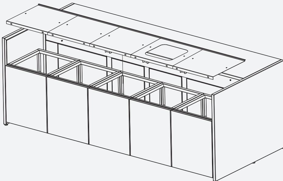
**19.** Montieren Sie das vordere Rechteckrohr mit 10 Stück M6x10.
