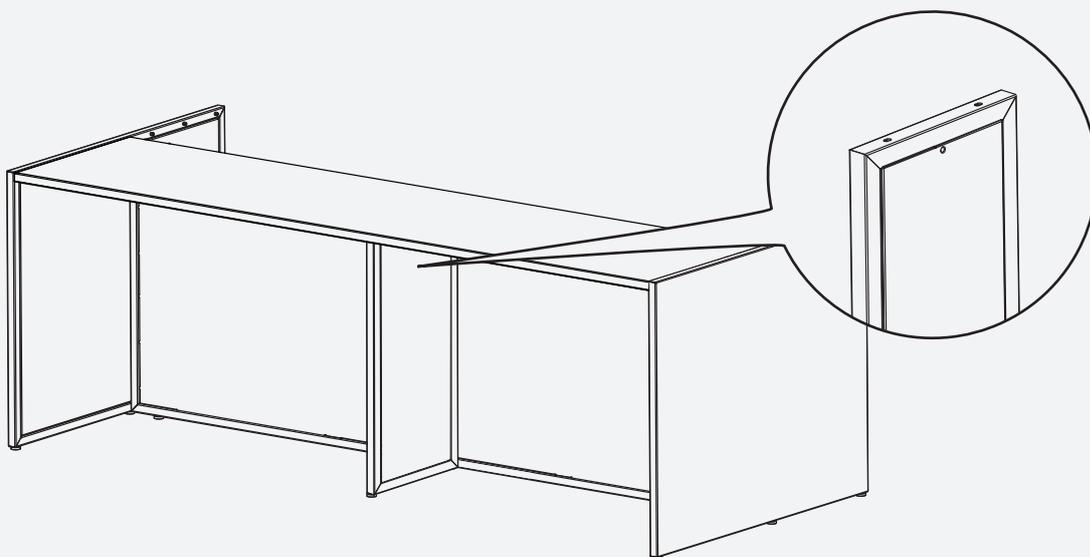
**8.** Montieren Sie die Bartheke mit 14 Stück M6x16.
