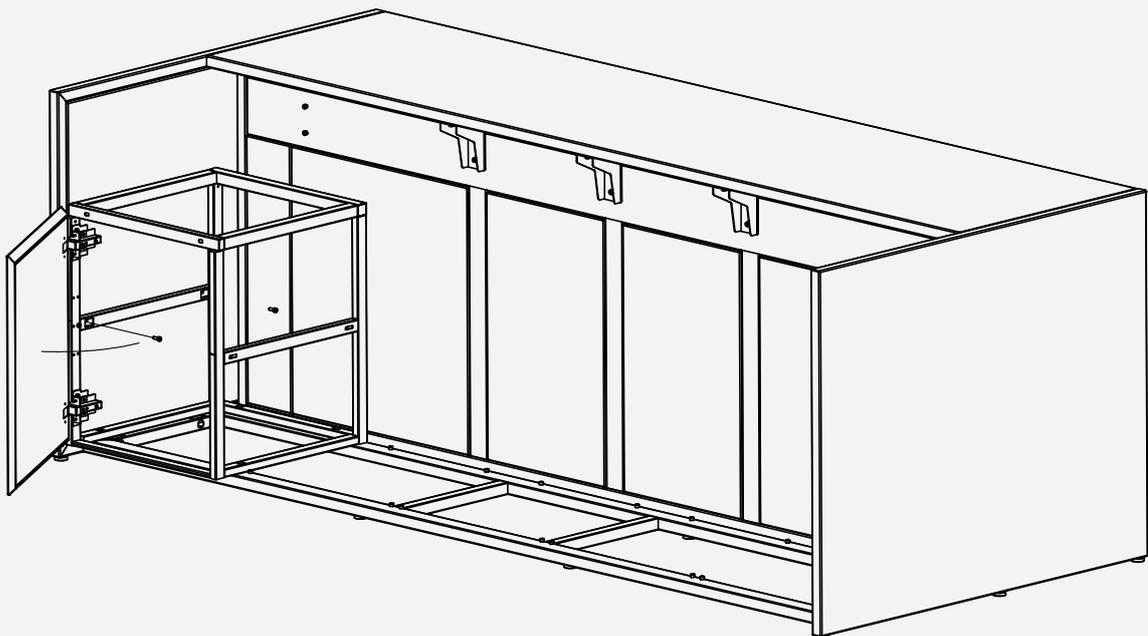
**18.** Platzieren Sie das obere Regal auf den Schränken. Stellen Sie sicher, dass der obere Regalboden des Schrankes mit dem Ausschnitt für die Spüle an der vordefinierten Position platziert wird.
