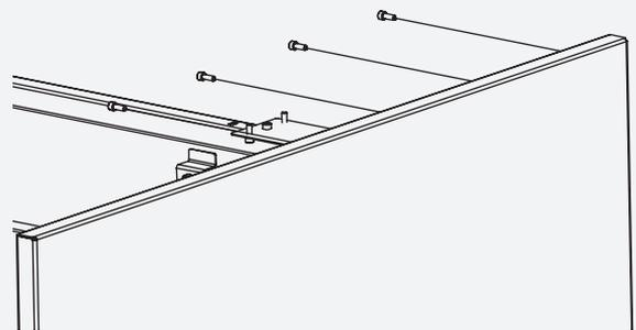
**8b.** Anschließend Deckplatte mit 6 Stk. montieren.
