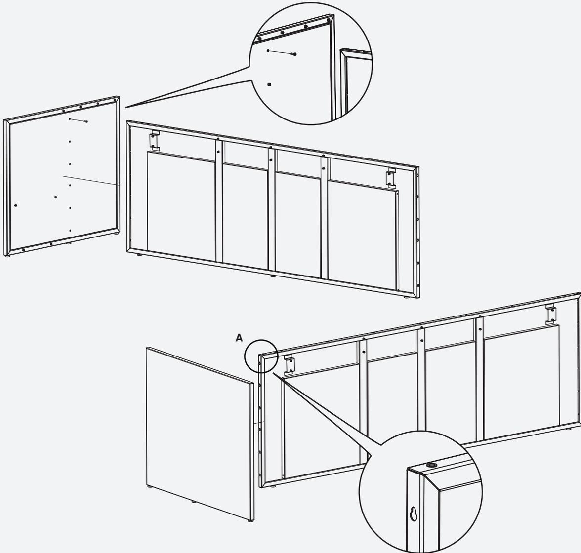
2. Schrauben Sie die restlichen 5 Schrauben mit 5 Stück M6x16 fest. Nicht vollständig anziehen, um die Einstellung zu ermöglichen.
