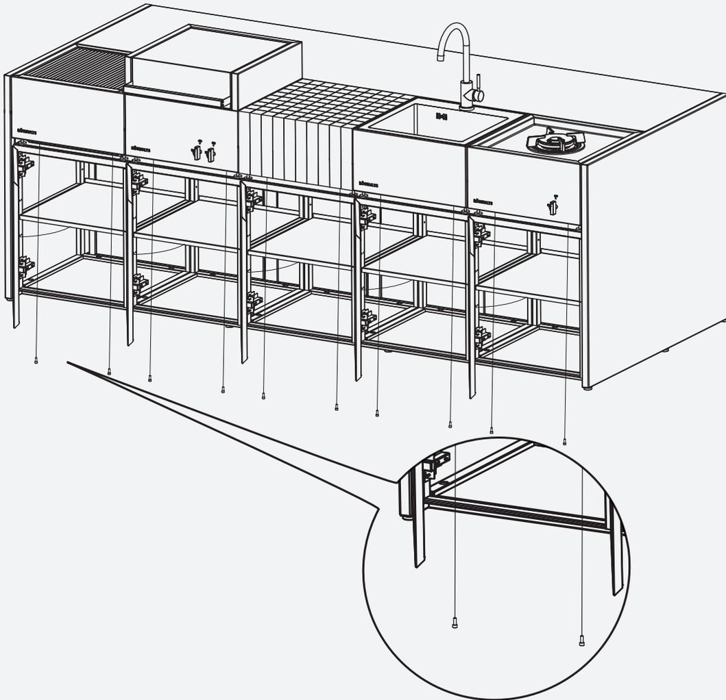
26. Platzieren Sie das Frontprofil. Es ist magnetisch, so dass es einrastet.
