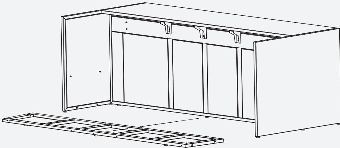
14. Dieser Schritt ist nur für **Kücheninsel 8 Module**. Montieren Sie 3 Stk. untere Stützen zwischen dem unteren Rahmen und der Mittelplatte, mit 12 Stk. M6x16, 4 Stk./Stütze.
