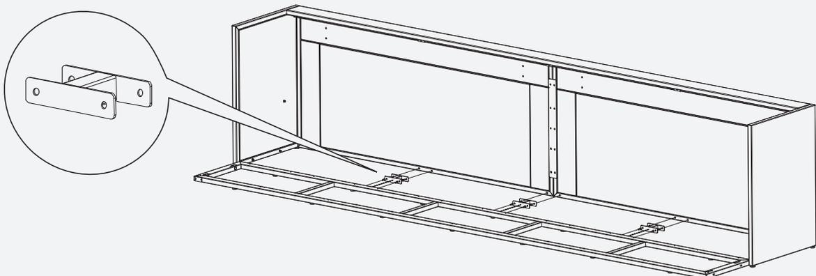
15. Grundrahmen mit 4 Stück M6x16 zusammenbauen. Nicht vollständig anziehen, um die Einstellung zu ermöglichen.
