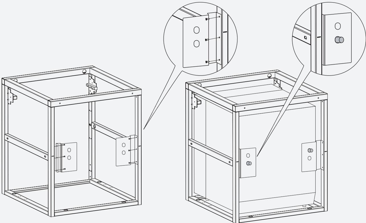
Möglichkeit, die Position der Scharniere und des Schließmechanismus nach links/rechts zu ändern.
