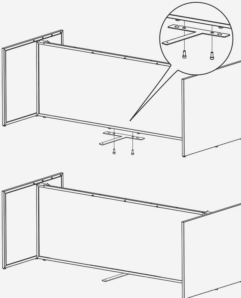
7.5 Montieren Sie die Paneelhalterung mit 1 Stück M6x16.
