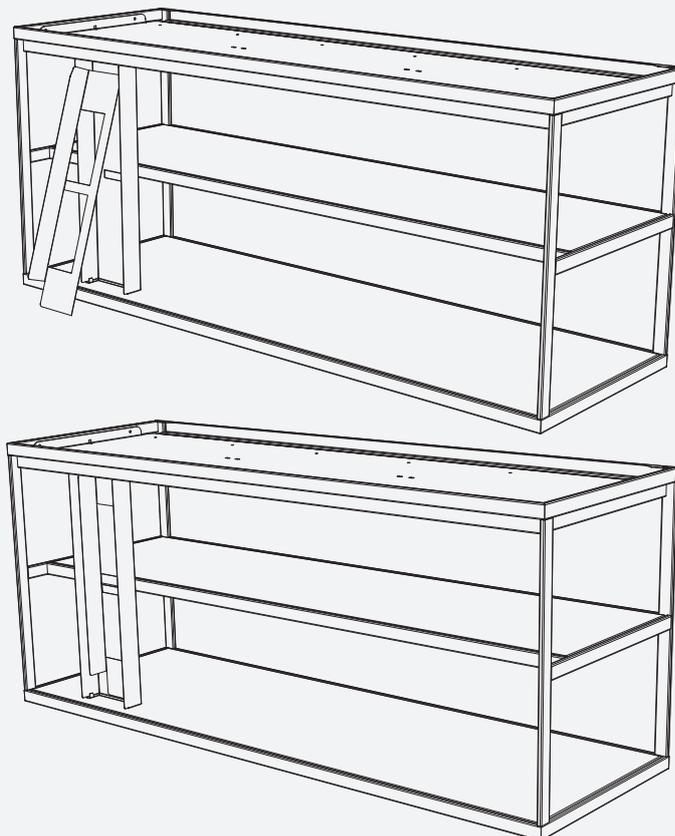
4. Coloque el soporte para mantener el canal de la manguera en su lugar.
