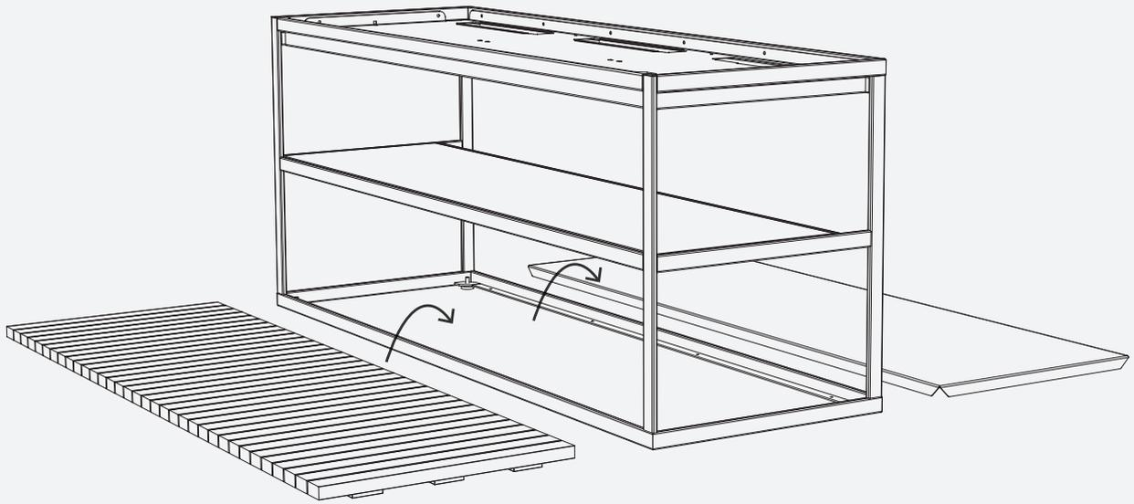
2. Asegúrese de que el marco esté nivelado y, si es necesario, compensar con los pies ajustables debajo del marco. Regulable 15 mm.
