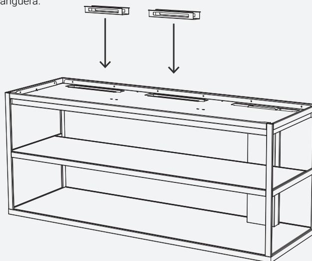
Coloque los módulos uno por uno en el marco y use los pies ajustables debajo de los módulos para nivelarlos. Luego, fije los módulos con tornillos M5 x 45 mm.
