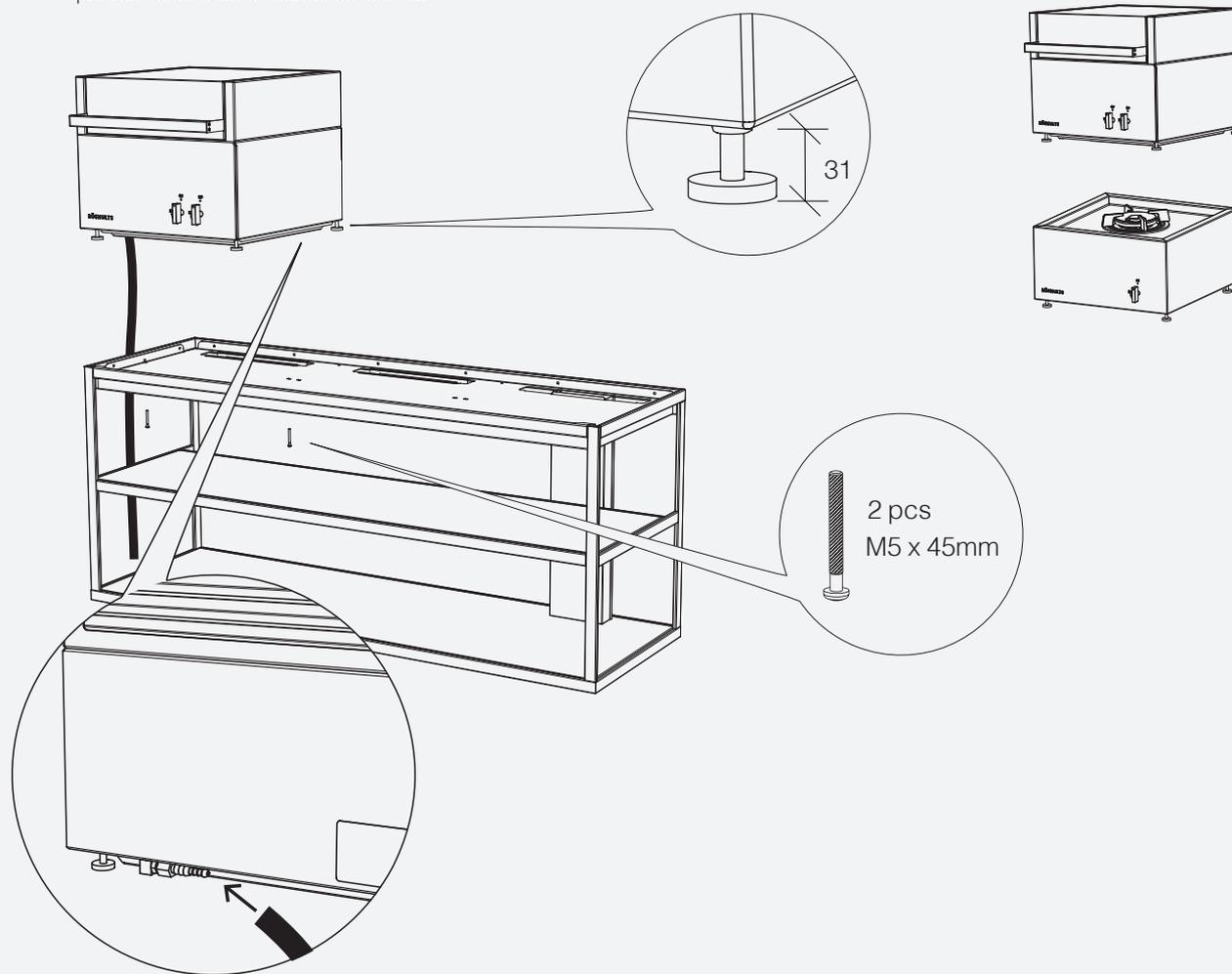
**6.3.2.** Conecte la manguera de gas a la parrilla de gas modular o la placa de cocina modular de la forma que se muestra.
