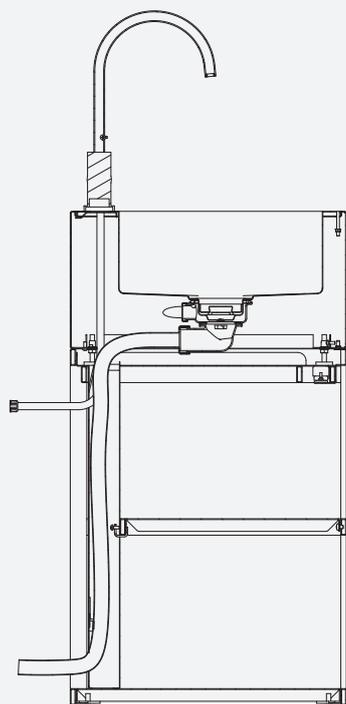
Medidas (mm) Marco cocina abierto 50.100 y 150, conexión agua / desagüe al suelo:
