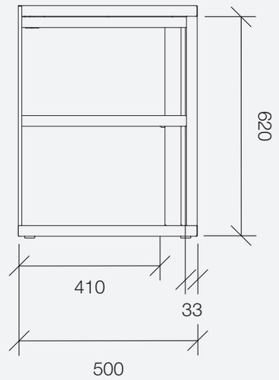
Medidas (mm) Marco cocina abierto 100, conexión agua / desagüe al suelo:
