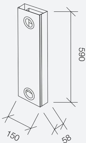
Medidas (mm) Marco cocina abierto 150, conexión agua / desagüe al suelo:
