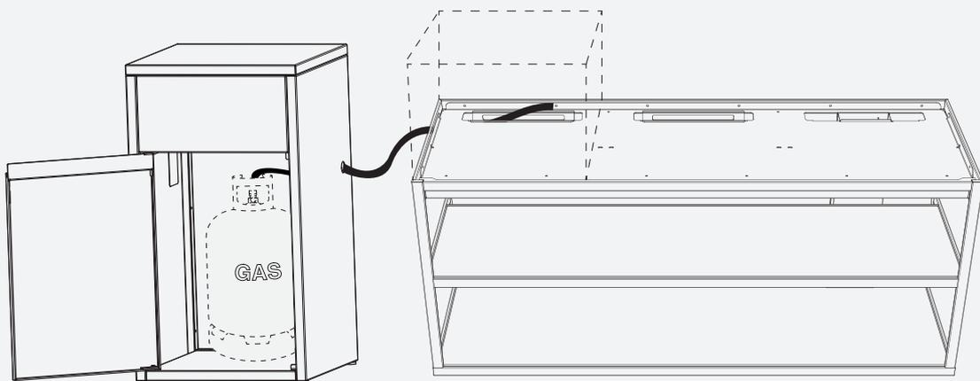
7. Coloque la tapa del canal de la manguera cuando todas las mangueras estén cableadas.
